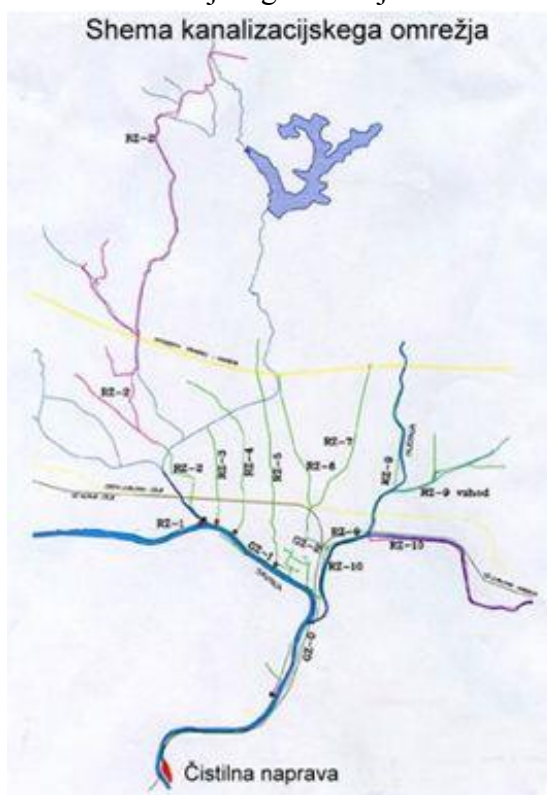
Slika 26: Shema kanalizacijskega omrežja
