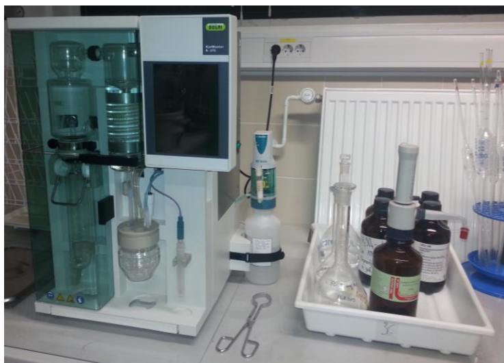
Slika 16: Naprava za določanje Kjeldahlovega dušika (titrator) Vir: Lasten
