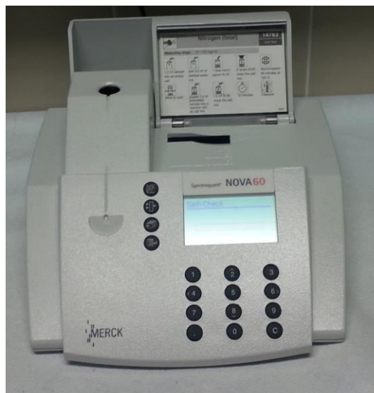
Slika 20: Določanje KPK (fotometer)
