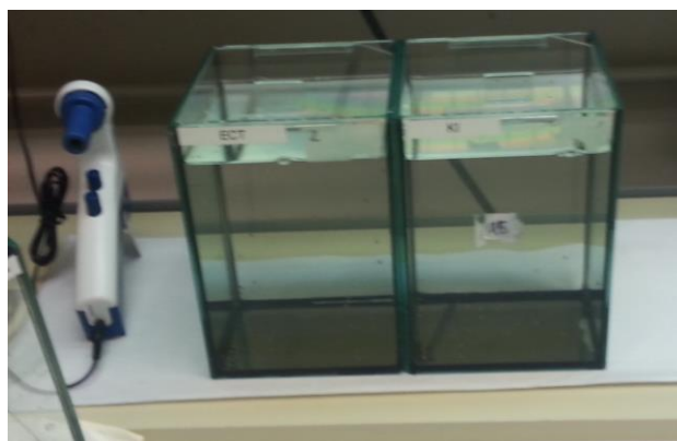
Slika 23: Določanje strupenosti z vodnimi bolhami Vir: Lasten
