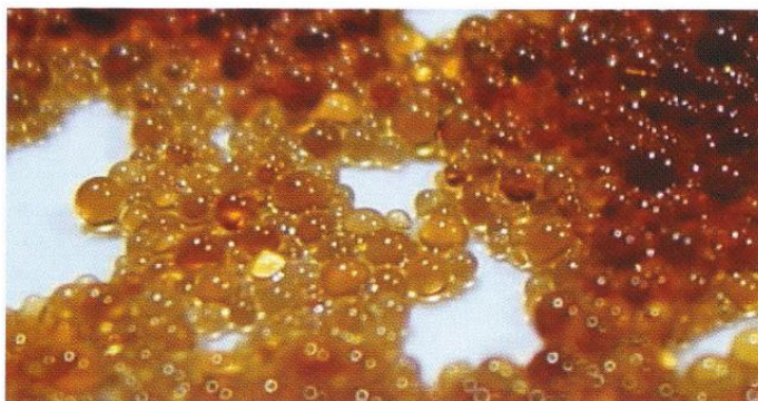
Slika 36: Zrna ionskega izmenjevalca (ionska smola)
